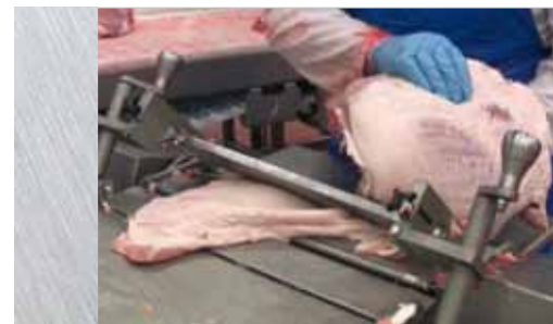
ESM 5550/1: Handhebel rechts und links zur Fettstärkeneinstellung.
