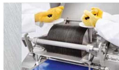
Ausbau der Schneidwalze
